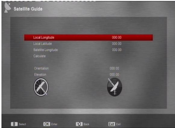
«Спутниковый гид» предназначен для расчета ориентации антенны на спутник, для этого необходимо ввести долготу и широту месторасположения своей антенны, и долготу спутника.
