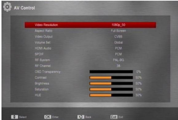
1. Разрешение видео: Задаёт разрешение видео сигнала используемое ресивером. Нажмите [OK] и кнопки [↑/↓] для выбора разрешения. Доступны следующие режимы: “480p\_60->480i\_30 ->576p\_50-> 576i\_25-> 720p\_60-> 720p\_50->1080i\_30->1080i\_25-> 1080p\_60 ->1080p\_50->Авто”. Выбор режима эквивалентен нажатию кнопки [V.Format] в режиме просмотра.
