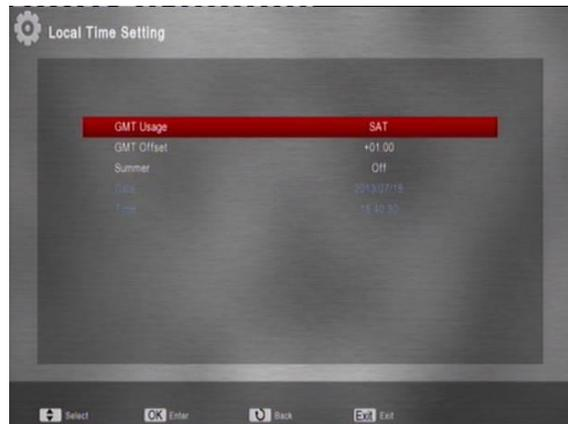
1. Источник времени: Определяет, как будет получена информация о времени. Кнопками [↑/↓] выберите “Спутник, Интернет или Вручную”. “Спутник” значит, что время будет получено со спутника, “Интернет” что источник данных о времени это сеть интернет.
